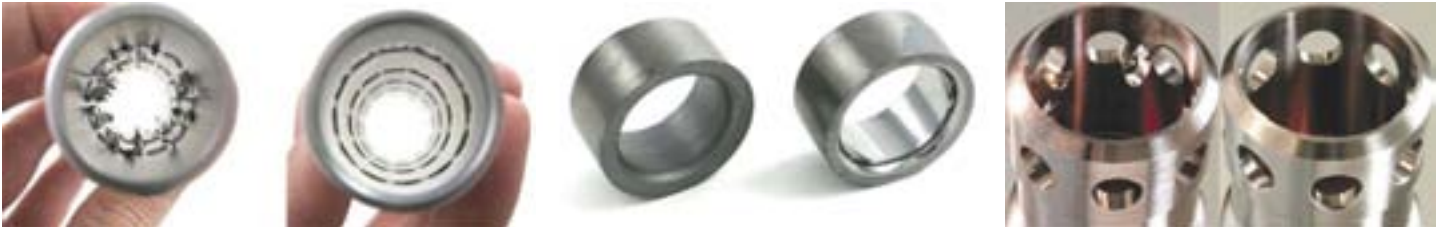
Flex-Hone ile işlem öncesi ve sonrası
